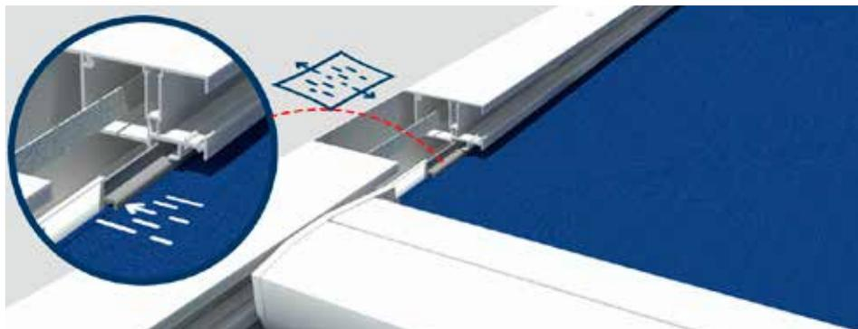
Le tela del techo se mantiene firmemente sujeta en las guías gracias a la tensión continua ejercida por el sistema de cremallera ZIP para pantallas tipo "screen".
